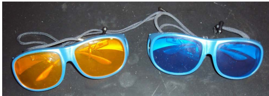
Figura 10. Lentes de seguridad para espectroscopía Raman. Lentes anaranjados para trabajar con el láser verde de 514 nm y lentes azules para trabajar con el láser rojo de 633 nm.
