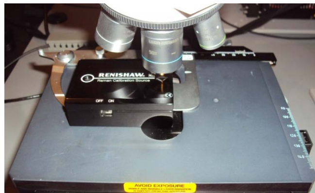
Figura 11. Porta muestra de calibración con cristal de silicio.
