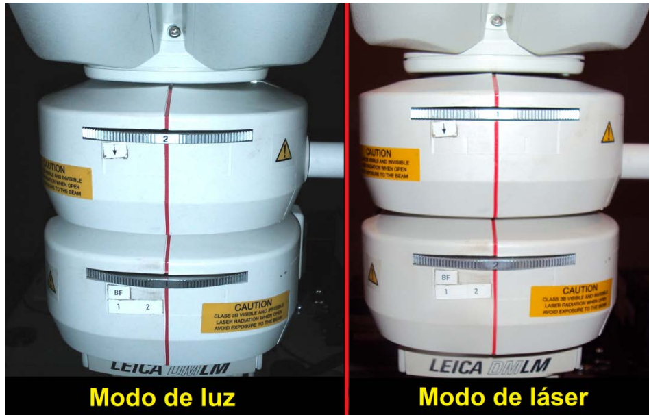
Figura 14. Selectores de modo de operación del microscopio.
