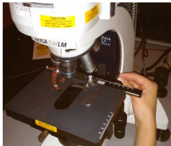
Figura 13. Palanca para ajustar la altura de la platina.
